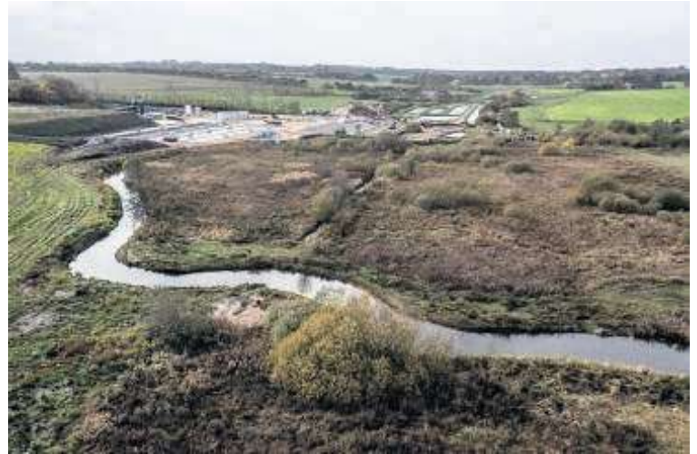
Hover Å er blevet genslynget på en lang strækning opstrøms i forhold til dambruget. Foto: Johan Gadegaard.
