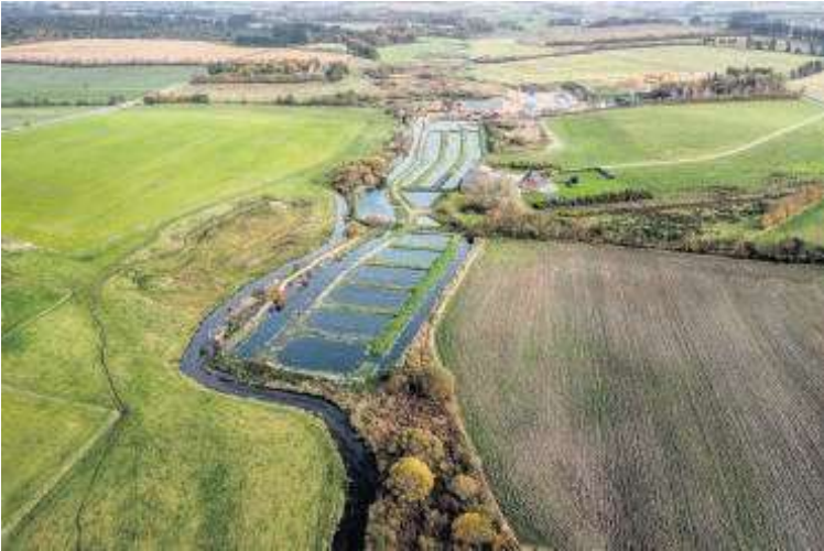
Det gamle dambrug er i dag en plantelagune, hvorigennem vandet fra det nye dambrug ledes, inden det i renset tilstand genledes til Hover Å. Foto: Johan Gadegaard.
